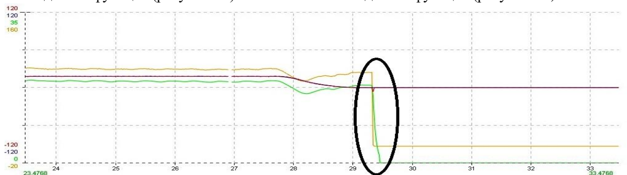
Рисунок 6.3 – Остановка синхронного двигателя без использования функции «Ограничения момента при останове»
