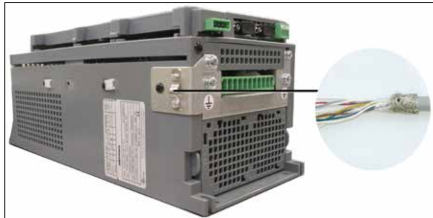
Рис. 7.2.4: Экранирующие соединения (рекомендуемые)
